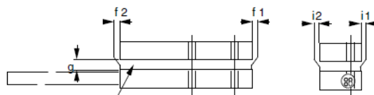
Capteur et aimant FACE À FACE / sensor FACE TO FACE with magnet
